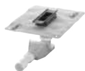
Modelo: 4981.80 Sifão standard Altura de constr.: 95–155 mm Retenção de água: 50 mm Cap. de descarga: 0,5–0,7 l/s*
