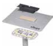
Modelo: 4981.90 Sumidouro vertical Altura mínima: 25 mm Sem sifão Cap. de descarga: 0,5–0,6 l/s
