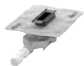
Modelo: 4981.81 Sifão para reabilitação Altura mínima: ab 70 mm Retenção de água: 25 mm Cap. de descarga: 0,4–0,7 l/s*
