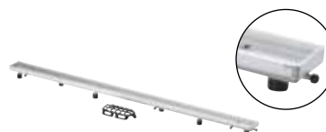
Grelha para calha de duche Advantix Visign ER13 para colocação de um revestimento em mosaico ou pedra natural a qualquer altura ajustáveis em altura, rebordo circundante 10 mm modelo 4982.70
