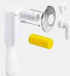
Sifão - para montagem na parede, tubo de esgoto da máquina de lavar roupa ou louça - material sintético equipamento Tubo de descarga vertical, parafusos de fixação, tampão de proteção para rosca, conexão de mangueira 90°, tampa, espelho em aço inoxidável controlo de qualidade segundo DIN 19541 modelo 5635.7
