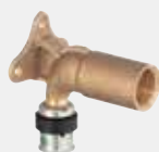
Joelho com pater Viega Smartpress com SC-Contur - bronze - conexão de prensar, rosca Rp - encurtável modelo 6725
