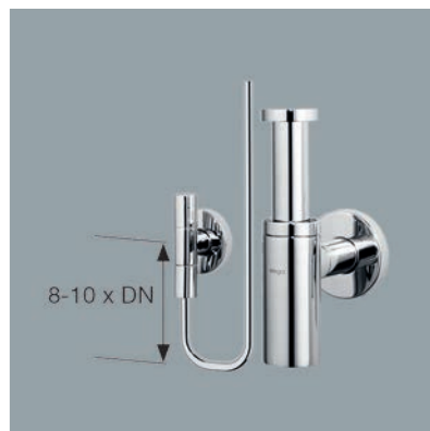
Fig. 1 – 17 Troço de arrefecimento em torneira de standard
