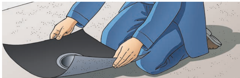
Fig. 3 – 19 Posicionamento da tela de impermeabilização
