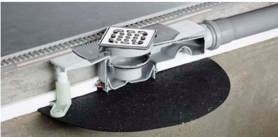
Sumidouro Advantix Top com proteção antirrefluxo graças à barreira de retenção de água com abertura de passagem ao centro e bolsas de retenção laterais.
