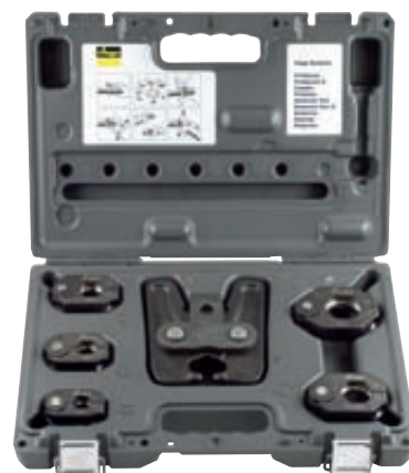
A mala de ferramentas inclui 5 anéis de prensar nas dimensões 15 a 35 mm e o mordente Z1 com função articulada. O outro conjunto da Viega inclui o mordente Z2 com os dois anéis de prensar nas dimensões 42 e 54 mm (sem imagem).
