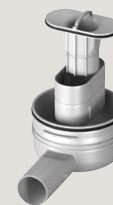
4982.92 Sumidouro para alturas de construção a partir de 95 mm, capacidade de descarga: 0,5–0,55 l/s, nível de retenção de água: 50 mm (encurtável para modelo de reabilitação)
